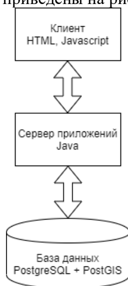
Рисунок 2.1 – Логическая структура программного комплекса
